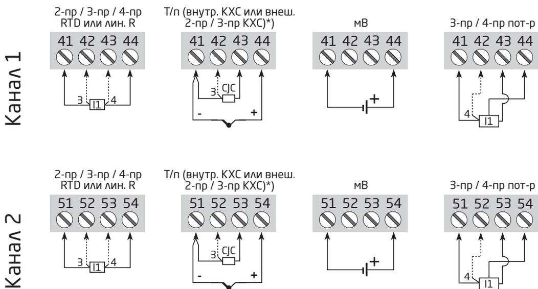
\* При использовании типа входа Термопара модуль 6437 можно настроить на постоянную, внутреннюю или внешнюю КХС с помощью чувствительного элемента Pt100 или Ni100. Этот выбор производится в процессе конфигурирования устройства.
